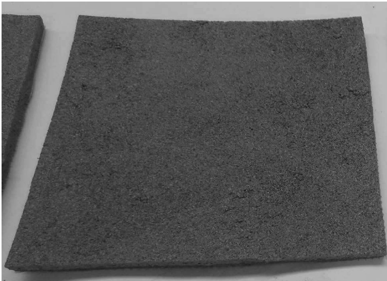
Figura 2. Parte frontale di un campione di “Suber” al termine dei 25 cicli sole-pioggia. Non sono stati rilevati deterioramenti di alcun tipo.
