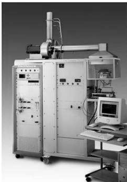
Fig. 1. Cono calorimetro utilizzato per le prove sperimentali
